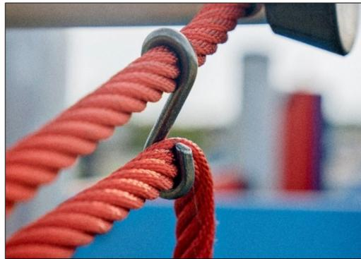
Die Corocord-S-Klemmen sind universale Verbindungselemente aus rostfreiem Edelstahl mit einem Durchmesser von 8 mm. Die Klemmen sind abgerundet und das gesamte Bauteil wird mit hydraulischen Spezialwerkzeugen auf das Seil gepresst. Daher können die Klemmen mit herkömmlichen Werkzeugen nicht entfernt werden.
