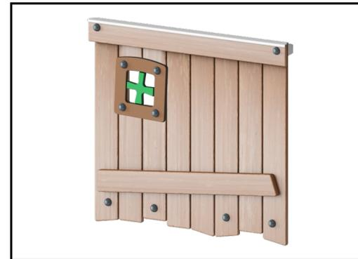
Version en bois de pin certifié FSC® (FSC®C004450) avec traitement de base par impregnation sous pression et finition supérieure peinte en brun. Les planches verticales et les extrémités supérieures sont protégées par un profil en aluminium unique pour une grande durabilité en extérieur.
