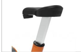
Der Sitz besteht aus spritzgegossenem, weichem PUR mit einer pulverbeschichteten Stahleinlage aus S235-Stahl. Die Nutzer können zwischen 9 verschiedenen Sitzhöhen wählen, die zwischen 845 mm und 995 mm liegen. Der Sitz ermöglicht es Nutzern mit einer Körpergröße von 150 cm bis 195 cm, das Fahrrad bequem zu nutzen.
