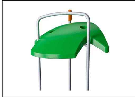
Die ELEMENTS™ Dächer bestehen aus recycelbarem PE-Kunststoff aus 33 % recyceltem Post-Consumer-Material mit einer Wanddicke von mindestens 5 mm, um unter allen Wetterbedingungen eine hohe Lebensdauer zu gewährleisten. Die Stahlrohre sind vollständig feuerverzinkt.
