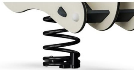
Los muelles KOMPAN están hechos de acero de resorte de alta calidad según EN10270. Los muelles se limpian mediante fosfatación antes de pintarlos con una imprimación epoxi y un recubrimiento de poliéster en polvo como acabado superior. Los muelles se fijan mediante accesorios anti-pelliczos únicos para máxima seguridad y larga vida útil.
