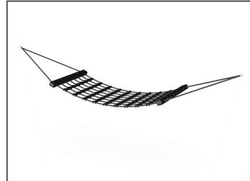
Le hamac est fait de cordes PES simples tressées de 16 mm renforcées d'acier. Le PES a une résistance élevée avec une excellente résistance à l'abrasion et aux rayons UV. Les boucles de corde sont reliées par des connecteurs en nylon (PA6) fournissant un hamac lisse et confortable.
