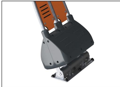
Die Schaukelbewegung vor und zurück wird durch ein hochbelastbares, skaliertes Doppelgummi-Torsionsfederelement gesteuert. Das Gummielement gewährleistet eine sichere Bewegung und reduziert die Geschwindigkeit in Richtung der Turmplattformen. Die Basisabdeckung ist aus geformtem PE-Material mit hoher Schlagfestigkeit hergestellt.
