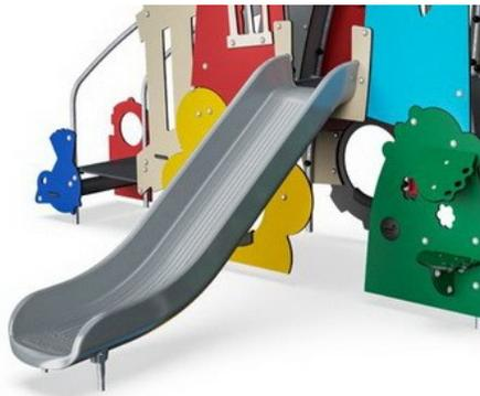
Die Rutsche besteht aus geformtem PE (Polyethylen) aus 33% Post-Consumer-Materialien in einem Stück mit einer Wandstärke von mindestens 5 mm und in verschiedenen Farben. Das PE ist auf UV-Beständigkeit getestet und hat eine ausgezeichnete Schlagzähigkeit und ist innerhalb einer großen Temperaturspanne verwendbar.
