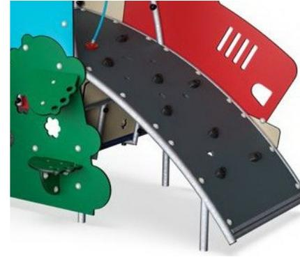
Die gebogene Kletterwand besteht aus Ekogrip®-Platten, die aus einer 15 mm dicken PE-Basis mit einer 3 mm dicken Deckschicht aus weichem Gummi mit einer Anti-Rutsch-Oberflächenstruktur bestehen.
