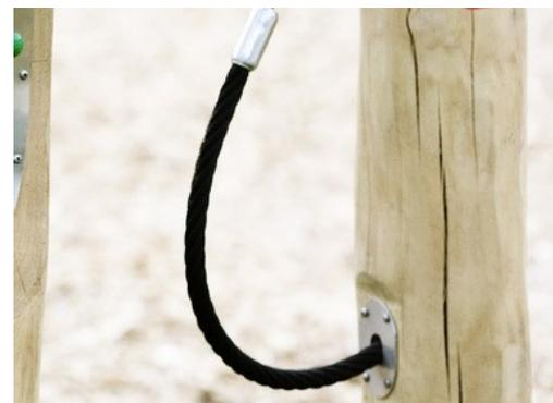
Le corde sono realizzate in PA stabilizzato ai raggi UV con rinforzo interno in acciaio. La corda è trattata con induzione al fine di creare una forte connessione tra acciaio e corda che porta ad una buona resistenza all'usura.
