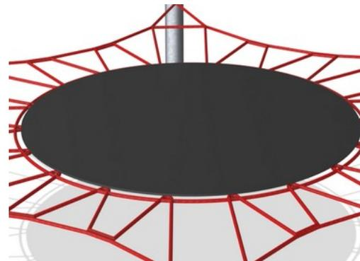
Les membranes Corocord sont constituées d'un matériau caoutchouc résistant au frottement, de qualité équivalente aux tapis roulant et possédant une excellente résistance aux UV. Testé et conforme aux exigences du règlement REACH en matière de HAP. Une armature à quatre couches en polyester tissé est intégrée. L'épaisseur total de la membrane est de 7,5 mm.
