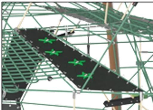
Le membrane Corocord sono realizzate in materiale gommatore antifrizione della qualità del nastro trasportatore con eccellente resistenza ai raggi UV. Testato e conforme ai requisiti REACH per PAH. Embedded è un rivestimento a quattro strati realizzato in poliestere intrecciato. L'armatura e i due strati superficiali producono uno spessore totale di 7,5 mm.
