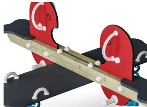
La poutre est en bois de pin provenant de sources européennes durables. Bois imprégné sous pression de classe 3 avec traitement au Tanalith E3475 selon la norme EN 335.
