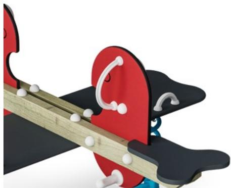
Les poignées et les repose-pieds sont faits de nylon moulé par injection de haute qualité (PA6). Le PA6 présente une bonne résistance à l'usure et aux chocs.
