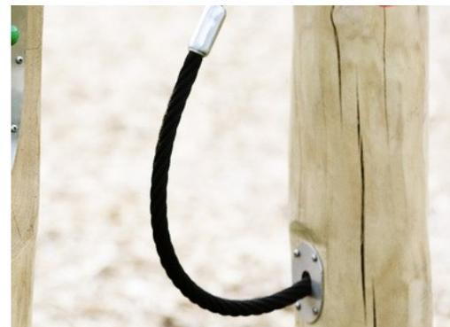
Les cordes sont fabriquées en PA doté d'une protection contre les UV avec un renforcement des câbles par une armature interne en acier. La corde est traitée par induction afin de créer une soudure solide entre l'acier et la corde et ainsi garantir une excellente résistance à l'usure.
