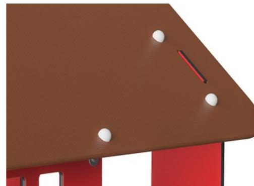
El techo está hecho de madera contrachapada de 16 mm de espesor hecha de aliso y madera de pino. Ambos lados están cubiertos por 2 capas de película fenólica con patrón de red antideslizante. Todos los bordes de corte están sellados con pintura para garantizar una larga vida útil.
