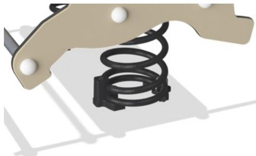
Les ressorts KOMPAN sont fabriqués en acier de haute qualité selon la norme EN 10270. Les ressorts sont nettoyés par phosphatation, avant d'être peints avec une amorce époxy et un revêtement thermolaqué de polyester en guise de finition. Les ressorts sont fixés par des raccords anti-pincement uniques pour une sécurité maximale et une longue durée de vie.
