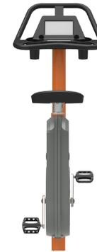
Der Q-Faktor des Arm bikes beträgt 175 mm, die Kurbel besteht aus 18 mm Edelstahl und verbindet die Pedalarme, die aus gegossenen Edelstahlteilen (Güteklasse 304) bestehen. Die Länge der Pedalarme beträgt 170 mm und die Pedale sind mit Standard-Fahrradbeschlügen verbunden.
