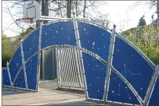
Das Tor hat eine Tiefe von ca. 140 cm und eine Breite von ca. 330 cm. Alle Pfosten sind aus galvanisiertem Stahl. Die Oberfläche ist feuerverzinkt. Der vordere Rahmen besteht aus Ø48-Rohren, und die Rückseite des Tores besteht aus 10 Rohren mit einem Durchmesser von ø38.
