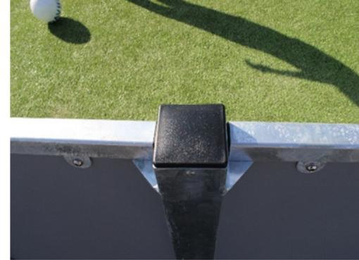
Los postes están hechos de un perfil de 80 x 80 x 3 mm con bridas soldadas horizontalmente de 6 mm. Esto permitirá una instalación fácil y una construcción sólida. Los postes de polietileno de baja densidad están unidos con remaches ciegos.
