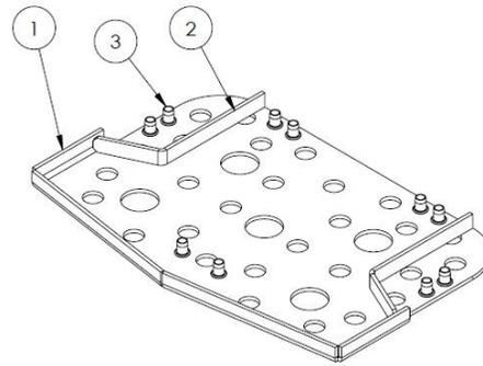
Una piastra in acciaio al carbonio zincato a caldo da 5 mm deve essere modellata all'interno dell'SBR per offrire stabilità ottimale e ottimizzare il montaggio del gradino sul telaio.
