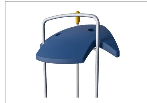
Střechy řady ELEMENTS jsou vyrobeny z recyklovatelného PE z 33 % tvořeného post-spotřebními materiály s minimální tloušťkou stěny 5 mm, aby byla zajištěna vysoká životnost ve všech klimatických podmínkách po celém světě. Ocelové trubky jsou žárově zinkované uvnitř i vně, aby byla zajištěna maximální životnost.
