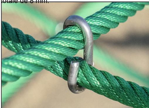
Les crochets en « S » de Corocord sont universellement utilisés dans les produits Corocord. Les tiges en acier inoxydable de 8 mm avec bords arrondis sont pressées autour des cordes avec une pince hydraulique spéciale, ce qui en fait le connecteur idéal : sûr, durable et anti-vandalisme, tout en permettant le mouvement typique des structures ludiques à cordes.
