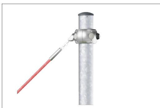
Chytré svorky Corocord jsou pečlivě navrženy do nejmenších detailů, aby byla zajištěna vynikající flexibilita vysoce kvalitního hliníkového materiálu. Chytré svorky se upevňují kolem sloupků pomocí čtyř ocelových šroubů. Nepoužívané upevňovací body jsou uzavřeny PA krytkami.
