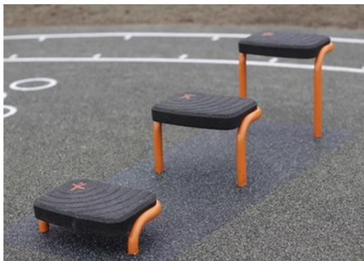
Il telaio di supporto è di 48,3 x 4 mm, in acciaio al carbonio, con una superficie zincata a caldo secondo ISO1461 e una classe di corrosione C3 secondo ISO12944-2. Il contenuto di piombo per le superfici è inferiore a 90 ppm.
