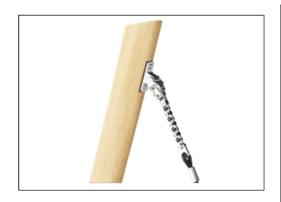
秋千吊架由不锈钢支架制成,可以在两个轴上移动。法兰轴承富含硅树脂,使悬架免维护。绳索的连接由不锈钢链条制成。
