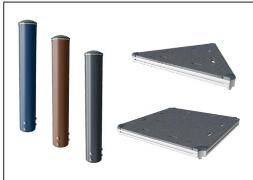
Die Hauptpfosten sind aus hochwertigem, vorverzinktem Stahl mit pulverbeschichteter Oberfläche hergestellt. Die Pfostenoberseiten sind mit Kappen aus UV-stabilisiertem Polyamid PA6 verschlossen. Die grau gefärbten, spritzgussgeformten Bodenplatten bestehen zu 75% aus recycelten Fischernetzen (PP-Material), und haben ein rutschfestes Muster und eine strukturierte Oberfläche.
