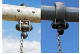
Le staffe a battente sono realizzate in nylon di alta qualità stabilizzato ai raggi UV (PA6) con cuscinetti a sfera integrati sigillati a vita. Le catene regolabili in altezza sono fissate da un gancio in acciaio inossidabile con bullone a occhiello serpente antifurto in un alloggiamento anti-rotazione. Tutti i sedili con due fissaggi a catena sono disponibili con sospensione standard o anti-avvolgimento.
