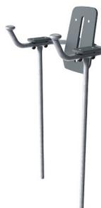
Le cadre de l'élévateur de jambe est en tube d'acier HDG Ø38 x 2 mm. Les plaques de support sont en Ekogrip® de 15 mm, une plaque en PE de 15 mm avec une couche supérieure de 3 mm de caoutchouc thermoplastique à effet antidérapant. Les supports de bras mesure 110 x 195 mm, espacés de 580 mm et 1315 mm au-dessus du sol. Le support dorsal mesure 335 x 500 mm. L'ouverture à l'arrière est de 30 x 350 mm.
