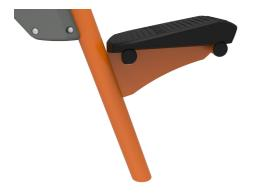
Le siège est recouvert d'un caoutchouc de polyuréthane et possède une plaque d'insertion en acier qui le relie au cadre en acier. Le siège est placé selon un angle à 12 degrés, permettant de positionner les sièges à des hauteurs de 550 à 620 mm.
