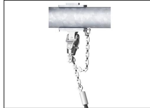
KOMPAN Schwerlast-Schaukelauflösungen aus rostfreiem Stahl mit Verdrehsicherung. Die Auflösungen sind mit zwei Bolzen am Querträger auf einer geschweißten Halterung befestigt. Die Lager sind mit Silikonschmiermittel versehen und benötigen keine weitere Schmierung.
