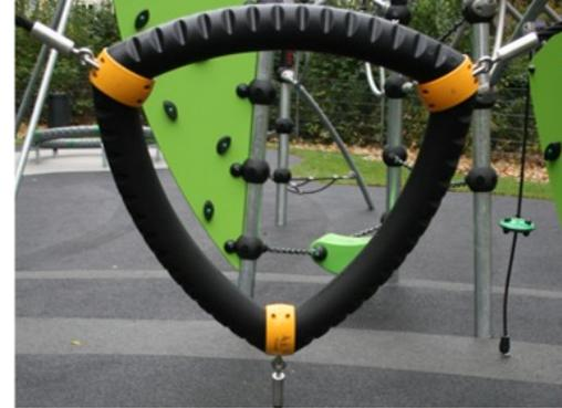
Galaxy-Dreiecksrahmen mit weicher PUR-Beschichtung und Eckwinkeln aus Perlon (PA6). Der Rahmen besteht aus pulverbeschichtetem Stahl und verfügt über integrierte Aufhängungspunkte in den Ecken. Die großen Dreiecksrahmen bestehen aus 18 mm starken EcoGrip®. Die TPE-Oberflächenbeschichtung sorgt für einen Anti-Rutsch-Effekt.
