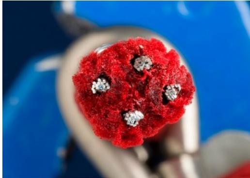
Les cordes Corocord 16 mm sont de type « Hercules » et se composent de fils d'acier galvanisé à quatre brins et d'une âme métallique en acier. Chaque toron est enveloppé hermétiquement dans du fil en PES. Les cordes sont très résistantes à l'usure et au vandalisme, et peuvent être remplacées sur place si nécessaire.
