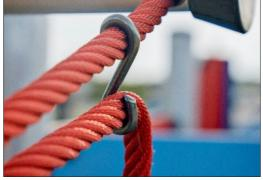
I morsetti a "S" di Corocord sono utilizzati come connessioni universali nei prodotti Corocord. Le aste in acciaio inossidabile da 8 mm con bordi arrotondati sono pressate attorno alle corde con una speciale pressa idraulica, rendendole il connettore ideale: sicuro, durevole e antivandalismo, il tutto pur consentendo il tipico movimento delle strutture di gioco della corda.
