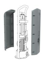
Le couvercle protège toutes les pièces mobiles du vandalisme et des piégeages. La couverture est faite de LLDPE rotomoulé de 5 mm, polyéthylène linéaire basse densité, avec une excellente résistance aux chocs et utilisable dans une large plage de température.
