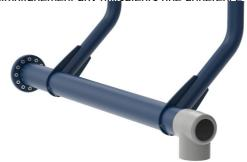
L'arbre d'entrée est en acier galvanisé à chaud Ø101,3 x 2,9 mm S355 et enduit de poudre. Le logement du roulement est en aluminium moulé (EN AB-44100 / EN AB-AISi12(a)) avec des roulements à billes scellés à alignement automatique. Une construction extrêmement solide et durable
