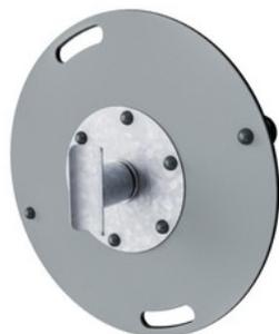
La caja de rodamientos está hecha de acero galvanizado en caliente. El eje del rodamiento está hecho de acero inoxidable AISI304. El rodamiento en sí está hecho de polioximetileno (POM), un termoplástico de ingeniería con alta rigidez, baja fricción y excelente estabilidad dimensional.
