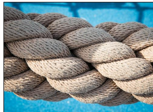
La Corde Coco en polypropylène (PP) possède un diamètre de 150 mm. L'ame de la corde en acier est munie de cosses aux deux extrémités, pour fixer la corde aux éléments de connexion existants.
