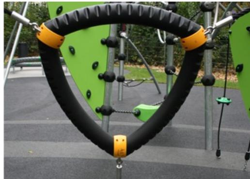
Triángulo de escalada GALAXY con capa exterior suave de PUR y soportes de esquina de nylon moldeado (PA6). El núcleo consiste en un marco de acero soldado con recubrimiento en polvo con puntos de suspensión de esquina integrados. Los triángulos más grandes se cierran con un panel Ekogrip® de 18 mm de espesor que tiene una capa superior de goma con un efecto antideslizante.
