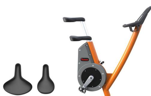
El sillín está hecho de caucho de poliuretano y tiene una placa de inserción de acero que lo conecta al pasador del sillín de aluminio. El sillín se puede ajustar a 13 alturas diferentes, utilizando un pasador de acero inoxidable.
