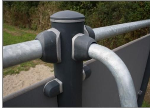
Die Verbinder sind aus druckgegossenem Aluminium hergestellt, das speziell für den Aussenbereich und starke Beanspruchung legiert ist. Die Schrauben zur Befestigung der Verbinder sind aus Edelstahl und durch Zink-Unterlegscheiben geschützt.
