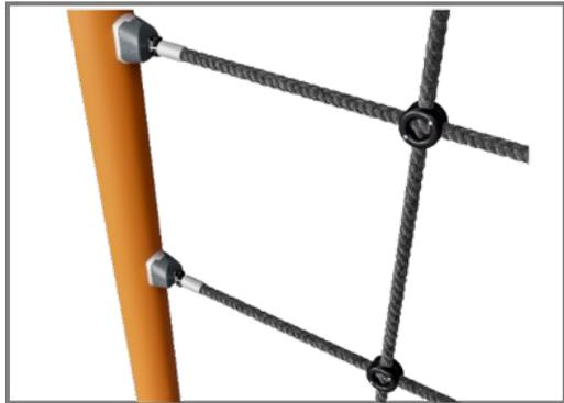
Corocord 16 mm Seile aus UV-stabilisierten PES-Litzen mit innerer Stahlseilverstärkung. Das Polyestergerm besteht aus +95% Post-Consumer-Materialien und wird induktiv auf jede Litze aufgeschmolzen. Damit sind die Seile besonders beständig gegenüber Abnutzung und Vandalismus. Corocord-Seile können jederzeit vor Ort ausgetauscht werden.
