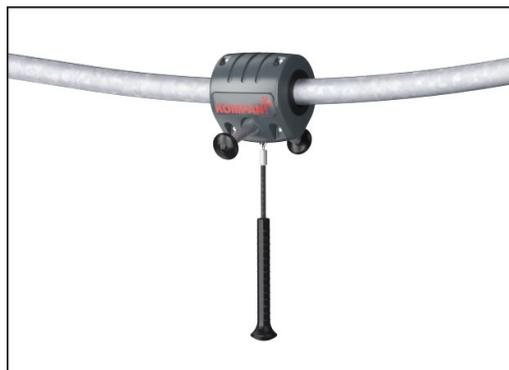
La agarradera está diseñada con un núcleo de acero soldado y cubierto con una carcasa de PE de baja densidad. Las dos manijas de acero galvanizado en caliente están en ángulo para proporcionar la mejor ergonomía posible mientras se desliza. Las ruedas del extractor están hechas de TPU de bajo ruido y se instalan con rodamientos de bolas sellados.
