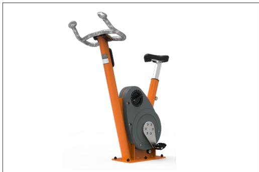
Het frame is gemaakt van S235 thermisch verzinkte stalen buizen met een afmeting van Ø76,1x3,6 mm, en met een poedercoating corrosieklasse C3 volgens ISO12944-2.
