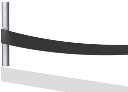
Membrana costituita da materiale gommato antifrizione della qualità del nastro trasportatore con eccellente resistenza ai raggi UV. Testato e conforme ai requisiti REACH per PAH. Sono incorporati due strati di armature in filo di acciaio zincato, che rendono la membrana estremamente resistente e antivandalismo. Il nucleo e gli strati esterni producono uno spessore totale di 10 mm.
