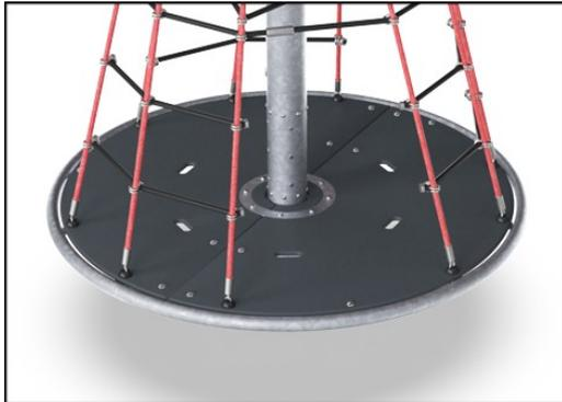
Todas las cubiertas están respaldadas por una construcción de acero única con múltiples soportes y fijaciones. Las plataformas HPL con un grosor de 17.8 mm tienen una resistencia al desgaste muy alta y presentan una textura de superficie antideslizante KOMPAN única.
