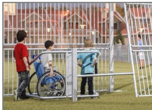
L'entrée pour fauteuil roulant est constituée de poteaux de 80 x 80 x 3 mm avec un tube de 48 mm de diamètre et de 2 charnières en acier inoxydable de 16 mm. L'ouverture mesure 95 cm de large et 112 cm de long, ce qui permettra aux personnes en fauteuil roulant d'entrer dans le MUGA, mais pas aux cyclomoteurs et autres véhicules motorisés.
