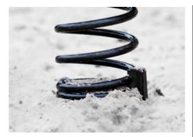
Los muelles KOMPAN están hechos de acero de resorte de alta calidad según EN10270. Los muelles se limpian mediante fosfatación antes de pintarlos con una imprimación epoxi y un recubrimiento de poliéster en polvo como acabado superior. Los muelles se fijan mediante accesorios anti-pellizcos únicos para máxima seguridad y larga vida útil.
