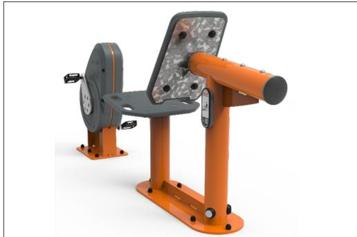
Um die Beständigkeit der Maschine zu gewährleisten, sind die orangefarbenen Hauptpfosten aus  $\varnothing 101,6 \times 3$  mm dickem S235-Stahl gefertigt, der feuerverzinkt und pulverbeschichtet ist.
