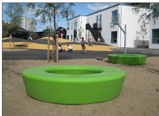
Les LOOPS peuvent être ancrés au sol en les remplissant d'eau ou de sable à l'aide des bouchons intégrés. Ils peuvent également être fixés à l'aide de supports de surface ou de sol.
