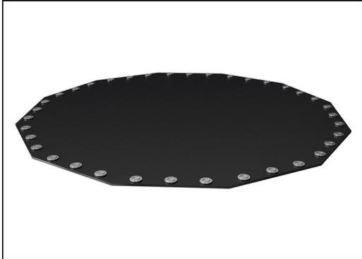
Les membranes rebondissantes sont constituées d'une bande transporteuse EP éthylène-propylène de 6,0 mm d'épaisseur avec une carcasse en tissu polyester polyamide. Les fixations à ressort sont renforcées avec des bagues en acier et des rondelles des deux côtés. La membrane est résistante à l'ozone et équipée de 8 trous d'évacuation d'eau placés au centre.
