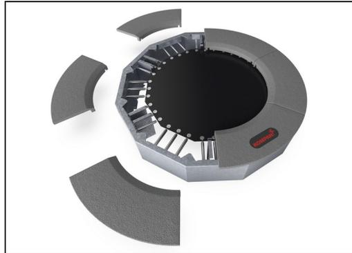
En tant que caractéristique unique, les carreaux SBR peuvent être retirés pour le nettoyage et l'entretien. En desserrant six vis, la tuile SBR peut être soulevée pour ouvrir et accéder aux ressorts (voir les instructions sur KOMPAN Master).
