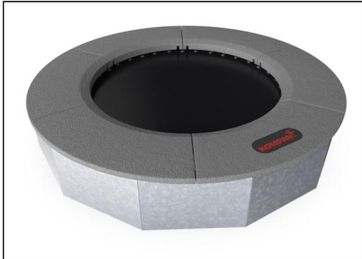
Tous les composants en acier sont fabriqués en acier au carbone S235 d'une épaisseur de 3 mm. Les panneaux latéraux, les murs de support pour le cadre supérieur, les plaques pliées avec SBR et les plaques plates pour le surfacage in situ sont galvanisés à chaud.
