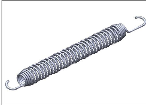
Les 36 ressorts sont en acier inoxydable pour assurer une durabilité et une excellente résistance à la corrosion. Le fil d'acier a une épaisseur de 3,2 mm et les cinq derniers enroulements sont en forme de cône pour assurer une longue durée de vie du trampoline.
