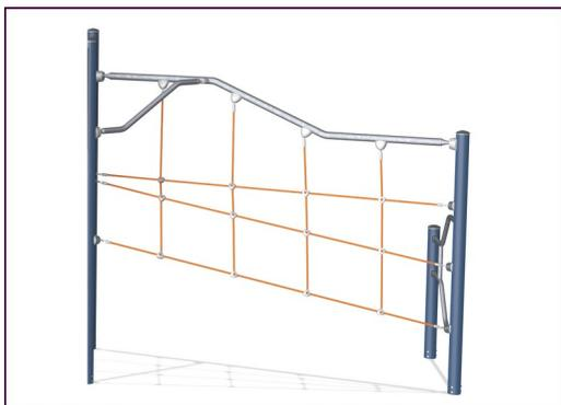
ELEMENTS 绳索具有六股钢丝和钢丝芯。每根绳索都用 PES 纱紧密包裹，然后将其融化到每根单独的丝束上。在最初的摩擦力去除了表面纤维之后，保留了较硬的 PES 涂层以保护每根股绳，从而使绳索具有极高的耐磨性和防破坏性。
