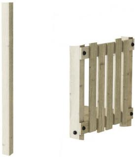
立柱和板材由欧洲符合可持续来源的松木制成。根据 EN335 标准，木材用 Tanalith E3475 标准进行 3 级压力浸渍（相当于 NTR AB 级）。根据要求，可提供 FSC® 认证（FSC®C004450）。
