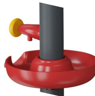
Il rubinetto dell'acqua integrato si apre quando viene premuto e si ferma quando si lascia andare. L'acqua viene fornita attraverso un tubo situato all'interno del palo con tubo di collegamento o tubo nella parte inferiore del palo. L'alimentazione può essere un tubo flessibile allentato o un piumaggio interrato permanente.
